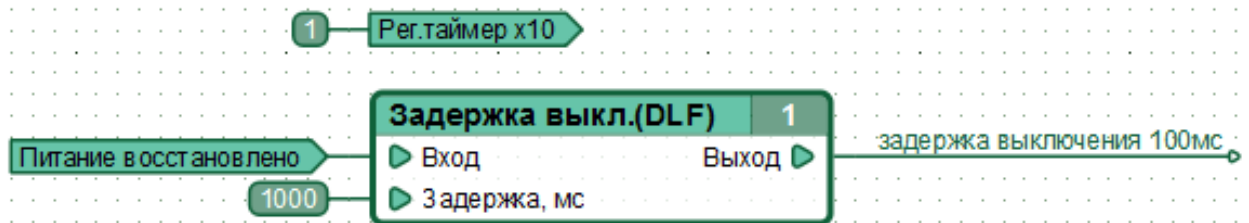
Рисунок 2.17 – Фрагмент функциональной диаграммы, устанавливающей задержку выключения 100\text{мс} , при использовании режима увеличения разрешения системного таймера.
