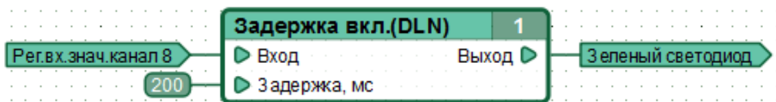
Рисунок 2.14 – Пример функциональной диаграммы, включающей встроенный зеленый светодиод контроллера при поступлении и удержании в течение не менее 200мс на соответствующем каналу №8 контакте контроллера, потенциала GND.
