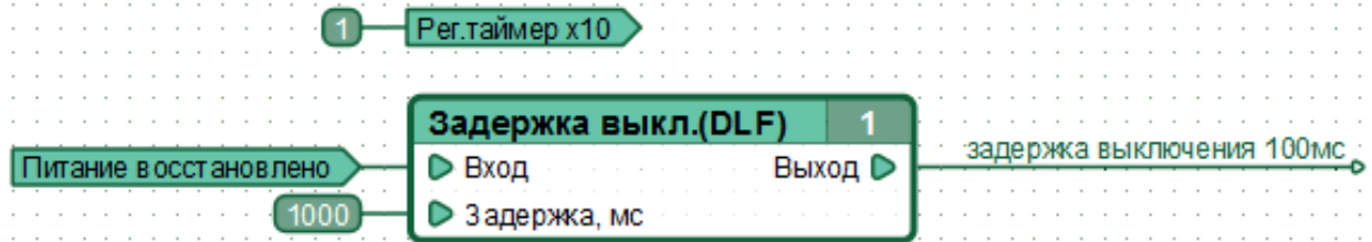
Рисунок 2.15 – Фрагмент функциональной диаграммы, устанавливающей задержку выключения 100\text{мс} , при использовании режима увеличения разрешения системного таймера.
