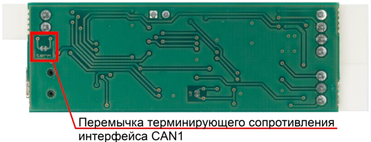
Рисунок 2.3 – Расположение перемычки «term»
